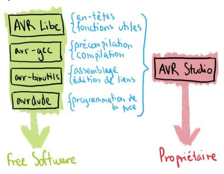
On remarque aussi ici avrdude, qui est l'outil permettant l'envoi du fichier de code machine (votre logiciel assemblé et lié) vers l'ATmega324PA.
