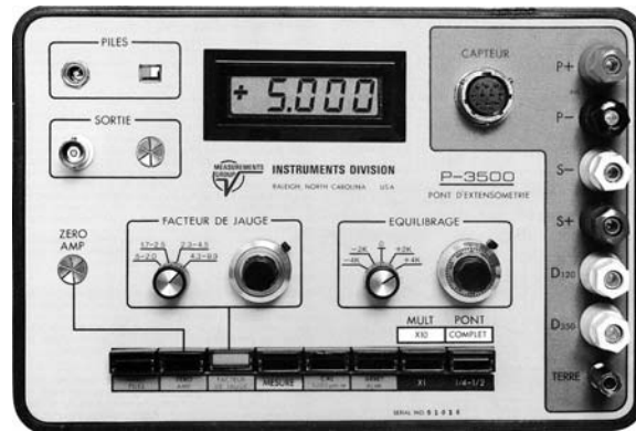
Figure 2.18 - Indicateur de déformation portable [ 1 ] p. 326
