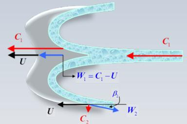
Dans l'industrie, on utilise des coefficients empiriques pour quantifier diverses vitesses dans la turbine en fonction de la vitesse maximale théorique générée par la chute  $H$ . Pour les turbines Pelton, il est pratique courante d'employer les relations:
