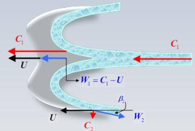
La force tangentielle du jet sur l'aube peut être obtenue à partir de la conservation de la quantité de mouvement, notamment:
