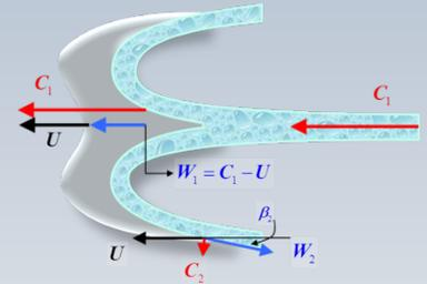
Lors du passage par l'aube, la vitesse relative est ralentie par le frottement du fluide contre la paroi ( $\dot{W}_2 \neq \dot{W}_1$ ) Ce phénomène peut être résumé par l'expression  $\dot{W}_2 = k\dot{W}_1$ , avec  $0 < k < 1$ . La formule pour la puissance devient alors
