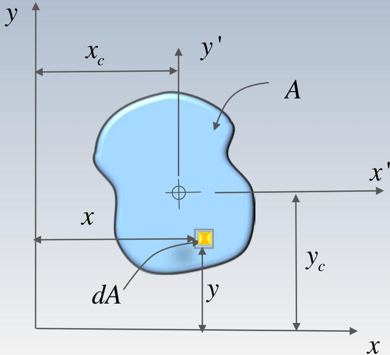
Le *rayon de giration* est la distance à l'axe de rotation à laquelle il faut placer un point de masse égale à celle du corps pour qu'il aie le même moment d'inertie que le corps.
