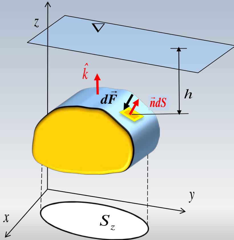
On regarde l'action de la pression  $p$  sur la surface élémentaire  $\vec{n}dS$  d'un corps immergé situé à une profondeur  $h$
