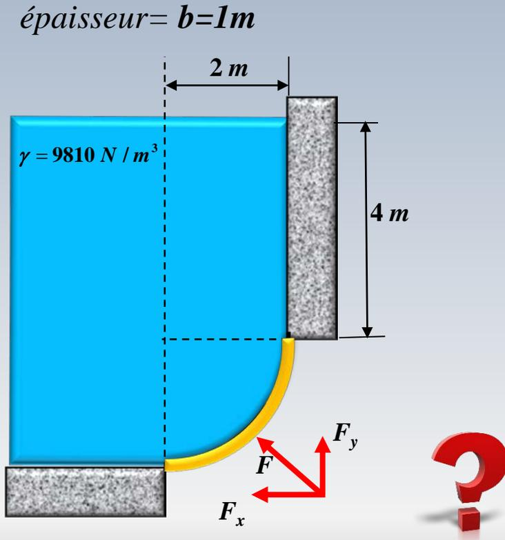
Déterminer les composantes horizontales et verticales  $F_x$  et  $F_y$  de la force de réaction, leurs points d'application et finalement la force résultante
