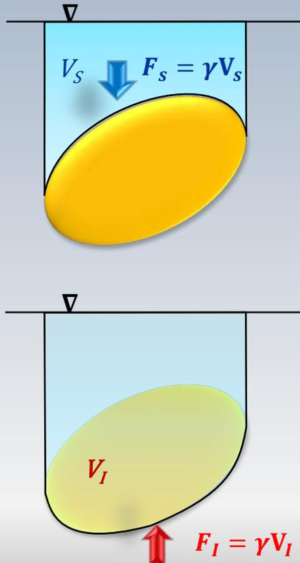
La force (vers le bas) sur la partie supérieure du corps immergé correspond au **poids**  $F_s = \gamma V_s$  du volume de la colonne de fluide comprise entre la surface du corps et le niveau libre du liquide. Également, la force (vers le haut) sur la partie inférieure du corps est donnée par  $F_I = \gamma V_I$ .
