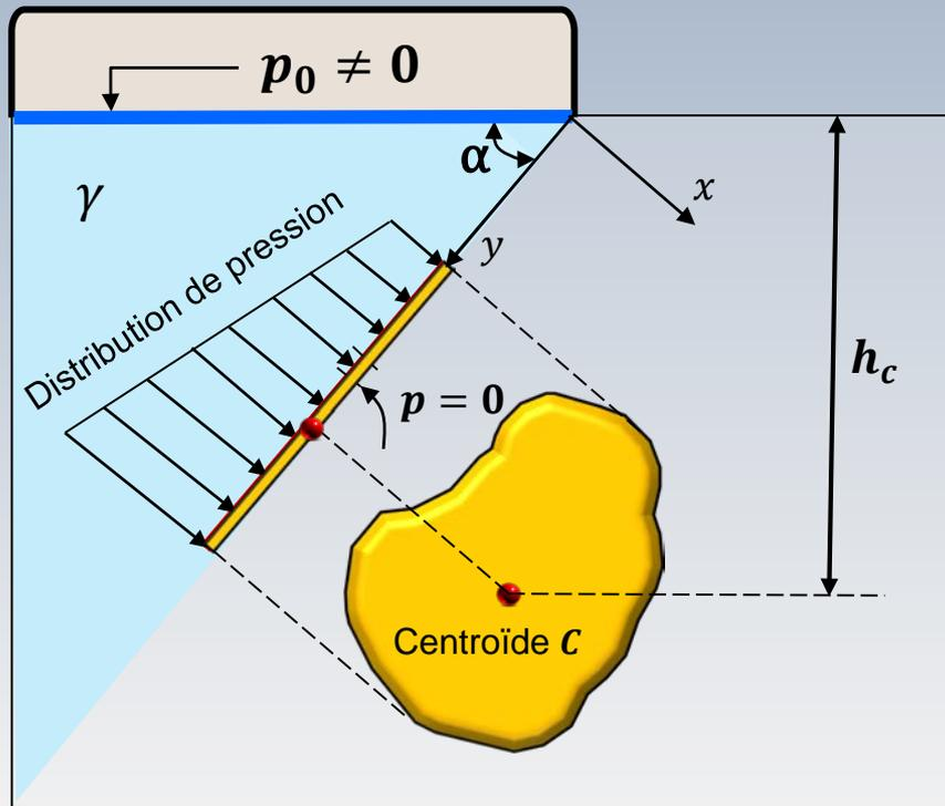
Lorsque la surface du liquide est soumise à une **pression jauge**  $p_0$ , les formules pour la grandeur de la force  $F$  et son point d'application  $y_c$  sont:
