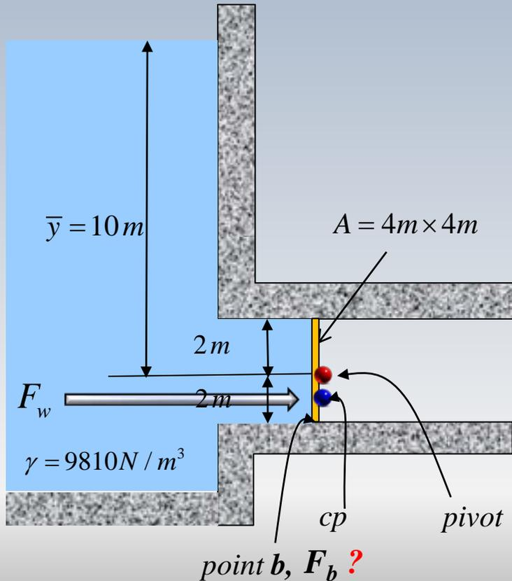
On doit trouver la force  $F_b$  nécessaire pour empêcher que la **vanne carrée** tourne par l'action de la force de pression
