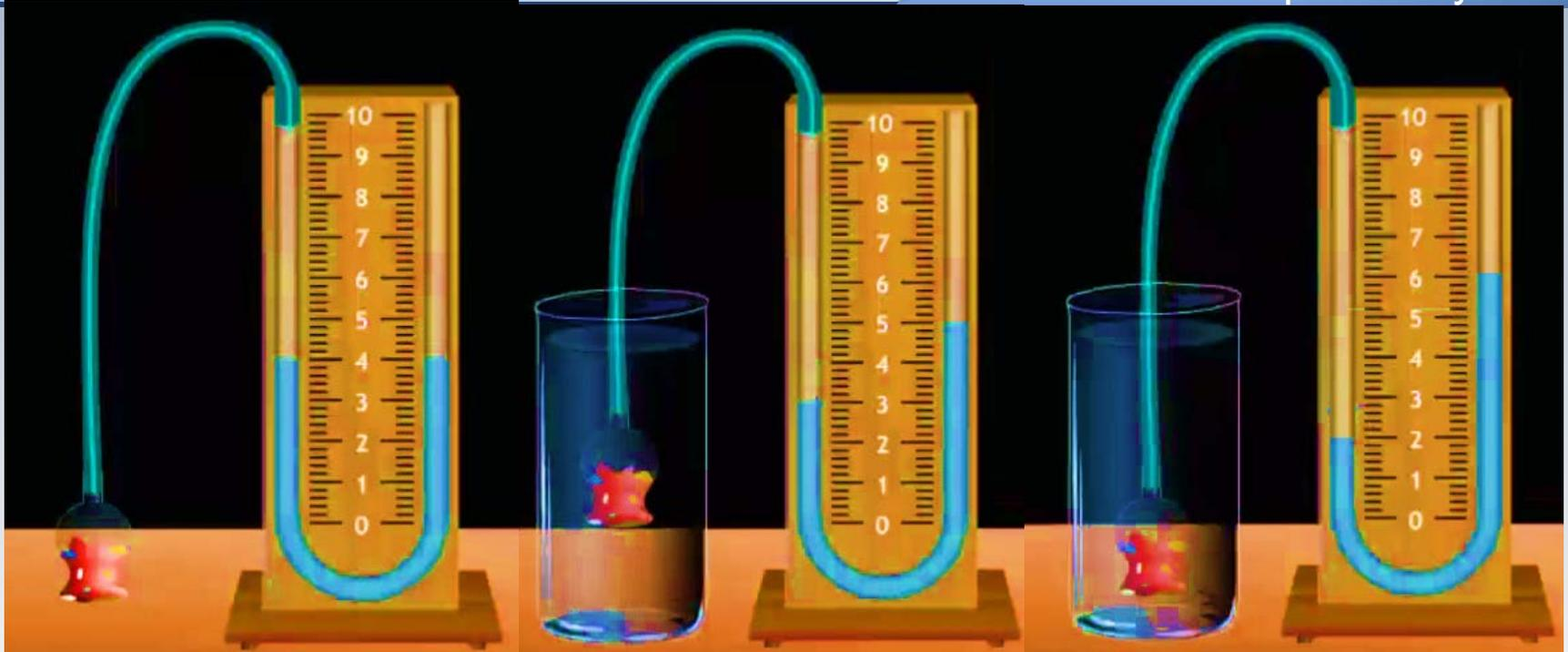
La différence de hauteur des branches du manomètre mesure la variation de pression à l'extrémité par rapport à la pression atmosphérique
