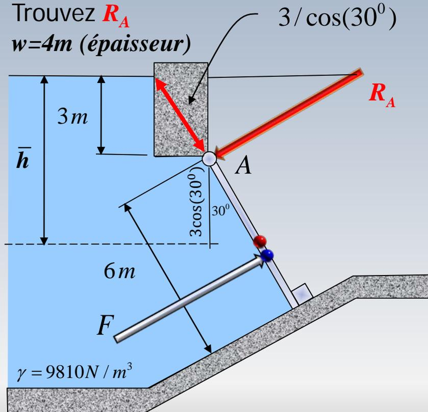
On doit trouver la force de réaction  $R_A$
