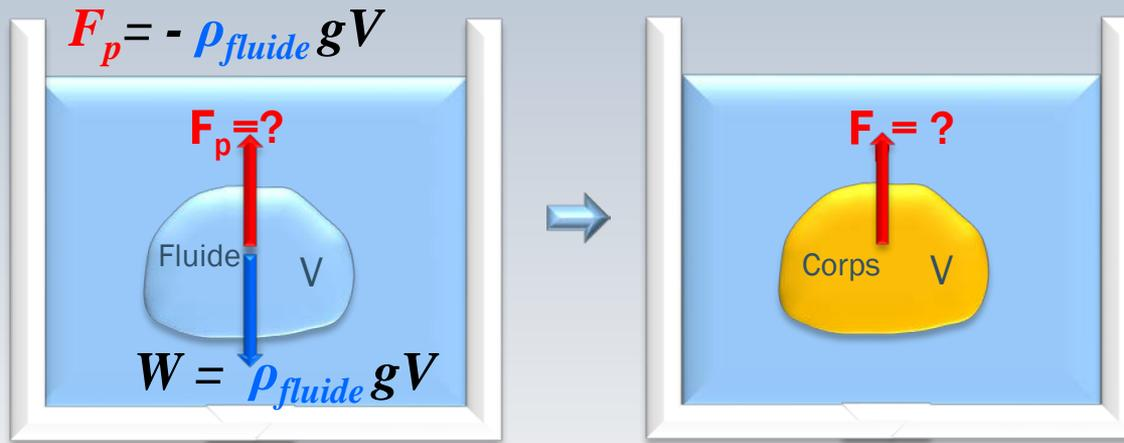
Le fluide est remplacé par un corps
