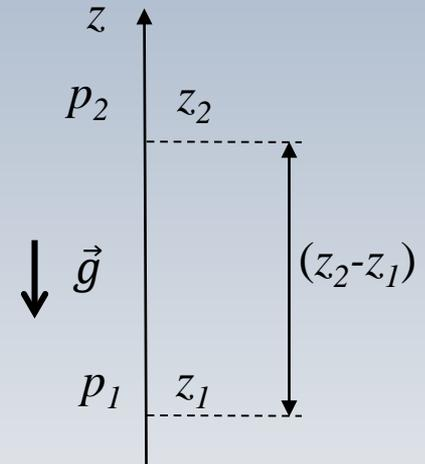
On verra plus tard que la hauteur manométrique (pressure head) c'est une mesure de la quantité d'énergie en pression.
