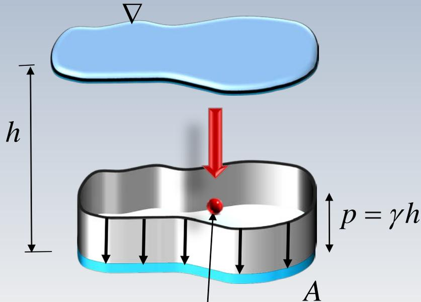
Pour une **surface horizontale**  $h = h_c = \text{cnste}$ ,  $\sin\alpha = 0$ . Alors, les formules pour la force et le point d'application deviennent :
