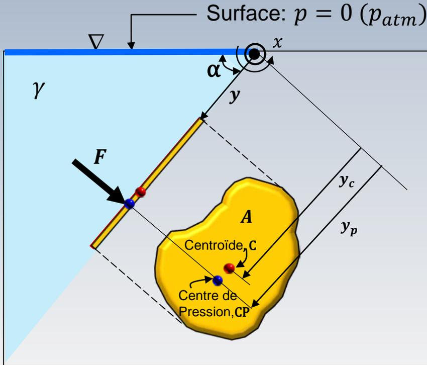
Puisque  $p_c = \gamma h_c$  et  $h_c = y_c \sin \alpha$ , cette formule peut s'écrire également en fonction de la pression au centroïde
