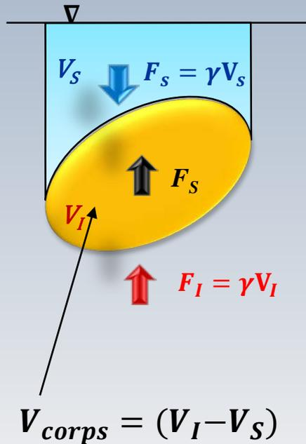
La sommation des forces  $F_S$  et  $F_I$  permet alors de redécouvrir le principe d'Archimède
