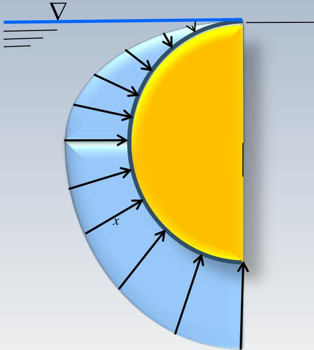
Puisque la grandeur des forces augmente avec la profondeur, on note aisément que la résultante des forces dans **la direction verticale** est vers le haut
