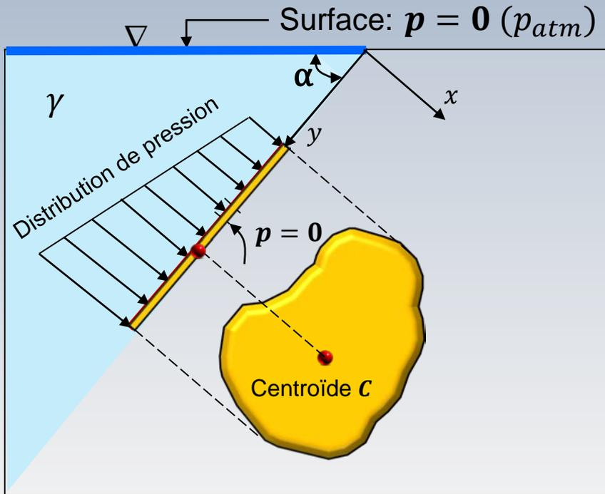
Pour étudier l'effet de la force produite par la pression hydrostatique sur une surface plane inclinée on a besoin de :
